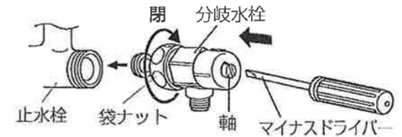
3. 分岐水栓の接続ねじ部が本体同梱の分岐水栓を接続しやすい方向に向ける。
